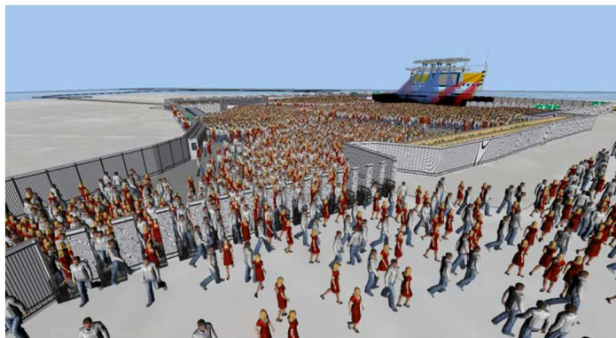
De simulatie van de loopstromen kan onder meer gevaarlijke zones met een (te) hoge dichtheid of een flessenhals opsporen en in kaart brengen.
